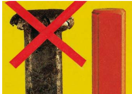
Meißelkopf – rechts fachgerecht angeschliffenes Schlagende
