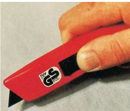
Messerklingenschutz durch Einzugmöglichkeit
