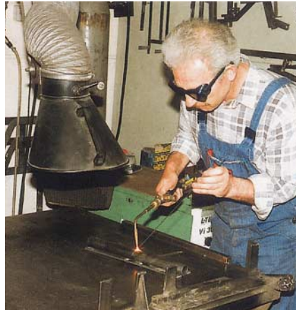
Absaugung der Schweißgase an der Entstehungsstelle
