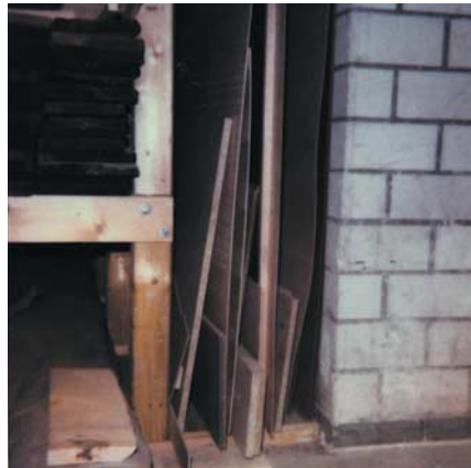
Lagerung von Platten (gegen Wegrutschen gesichert)
